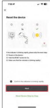
[Sólo para el módulo ZigBee] Seleccione la pasarela ZigBee con la que desea emparejar el módulo. Esta pasarela debe añadirse en la aplicación antes de emparejar el módulo. Reinicie el módulo manteniendo pulsado el botón RESET durante 5 segundos o accionando el interruptor físico 6 veces (6 veces on-off) y comprobando que el LED parpadea.
