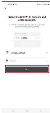
Reinicie el módulo manteniendo pulsado el botón RESET durante 5 segundos o accionando el interruptor físico 6 veces (6 veces on-off) y comprobando que el LED parpadea. Introduzca el nombre y la contraseña de su red Wi-Fi. Esta información permanece encriptada y se utiliza para permitir que el módulo se comunice con tu dispositivo móvil de forma remota.
