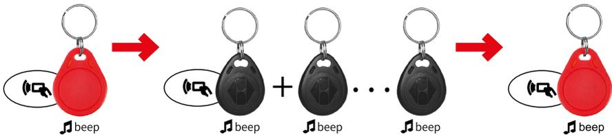
Das gleiche Verfahren kann zum Löschen von Chips verwendet werden - legen Sie zuerst den roten Chip an, um den Löschmodus zu starten, legen Sie dann nach und nach die Chips an, die Sie entfernen möchten, und legen Sie schließlich den roten Chip wieder an, um den Modus zu beenden.
