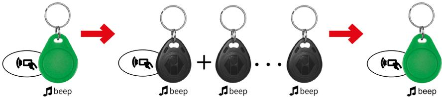
1. Halten Sie den grünen Chip an die zum Einlesen vorgesehene Fläche der Klingel. Es ertönt ein Piepton - das Gerät wechselt in den Modus für die Kopplung der Chips.
