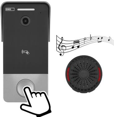
Nach der ersten Initialisierung halten Sie die mittlere Taste 5 Sekunden lang gedrückt, bis die roten LEDs aufleuchten.
